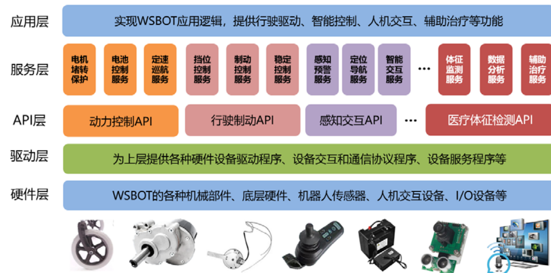
图 1 轮式服务机器人的分层实现架构
