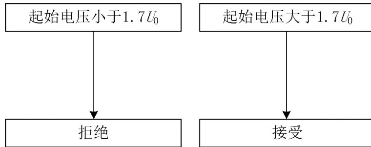
图 E.1 110kV 电缆本体交流激励式振荡波局部放电检测的决策流程图
